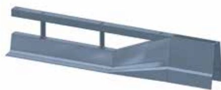
Übergang auf Betongleitwände
